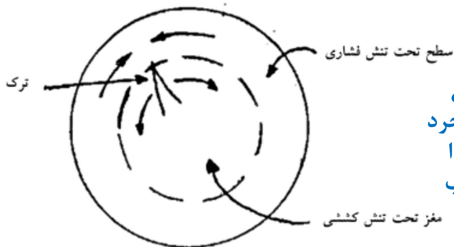
شکل ۹-۹ شمایی از چگونگی شروع و پیشرفت ترک در شرایط سخت شدن پوسته ای [۳۷].
